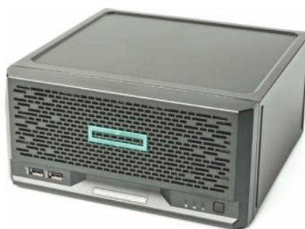
Der kompakte HPE ProLiant MicroServer Gen10 bietet ECC-RAM und Funktionen zur Fernwartung ab etwa 700 Euro.
