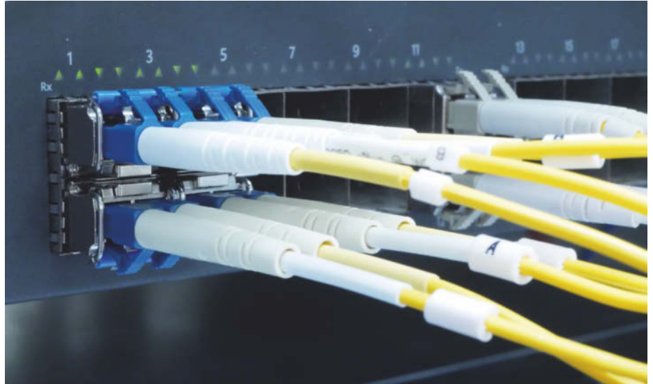
Singlemode-SFP-Module übertragen 1 GBit/s auch über große Distanzen.
