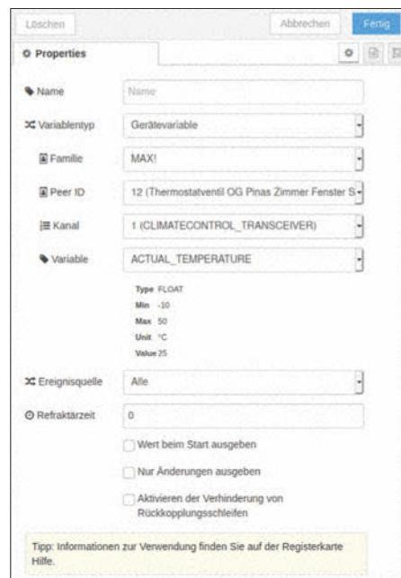
Homegear nennt die Nodes für Befehle an die Geräte „Variable“. Diese Variablen können sowohl auslesbare Werte wie die aktuelle Temperatur als auch Befehle mit einem übertragenen Parameter wie eine Wunschttemperatur sein.
