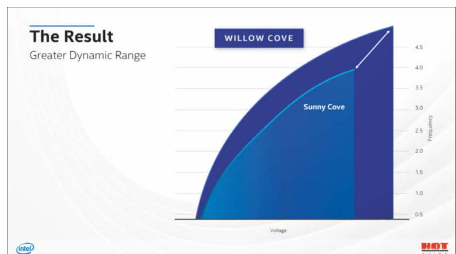
Intels Willow-Cove-Kern für die 11. Core-i-Generation soll dank der neuen SuperFin-Transistoren durchgängig eine höhere Leistung bieten als der bisherige 10-Nanometer-Kern Sunny Cove.
