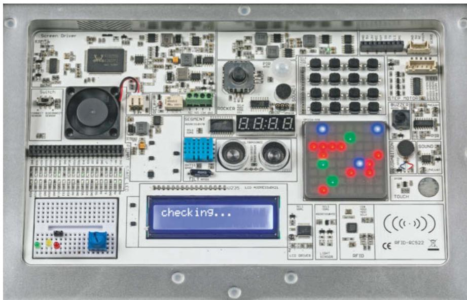
Gut zwei Dutzend Sensoren, Displays, Steuermodule und Eingabemöglichkeiten sind betriebsfertig auf dem Experimentierboard untergebracht, das sich unter der drahtlosen Tastatur verbirgt.
