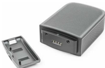
In den Surroundlautsprechern der JBL Bar 9.1 stecken Akkus. Alternativ kann man sie über 5-Volt-Netzteile mit Micro-USB-Anschlüssen (nicht im Lieferumfang) versorgen.
