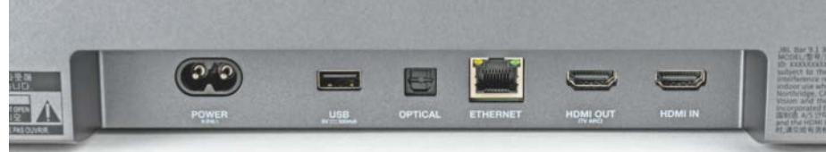
Über den USB-Anschluss auf der Rückseite lassen sich bei der US-Version MP3-Dateien von Speichermedien abspielen. Bei der deutschen Ausführung dient er hingegen nur Servicezwecken.
