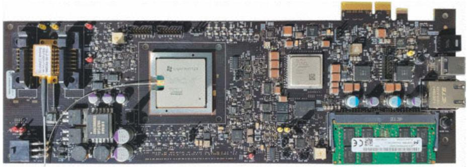
Statt mit Strom multipliziert der „Mars“ von Lightmatter mit Laserlicht. Ein DAC übersetzt Neuronenaktivierungen in Lichtintensität und 64 Mach-Zehnder-Interferometer gewichten die Laserleistung mittels Phasenverschiebung, die sich über kleine Kondensatoren steuern lässt. Ein ADC übersetzt das Ergebnis anschließend wieder in die digitale Welt.
