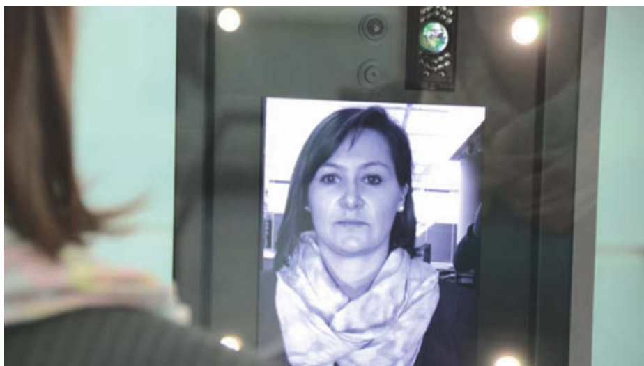
Der Algorithmus im System berechnet die biometrischen Merkmale des Live-Kamerabildes sowie des auf dem Ausweis gespeicherten Fotos und vergleicht diese miteinander.
