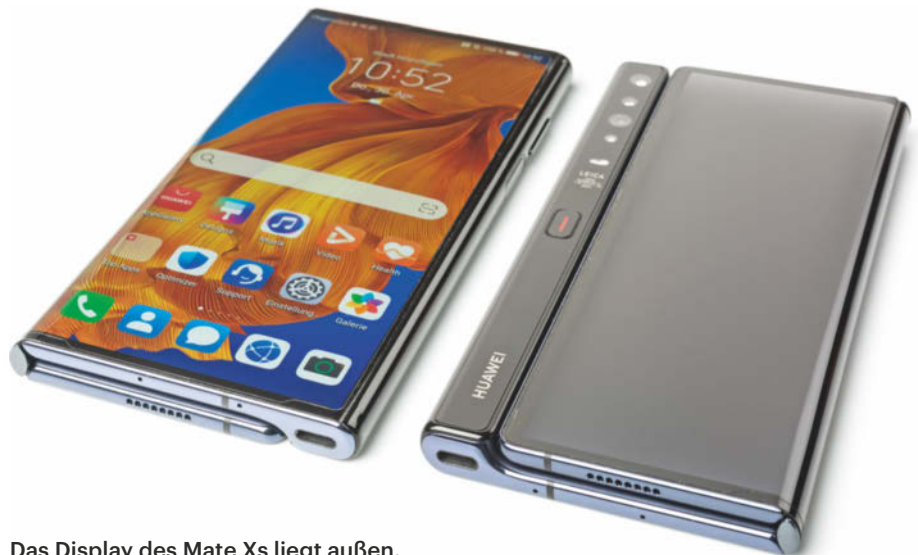
Das Display des Mate Xs liegt außen. So konnte Huawei recht schmale Spaltmaße realisieren.
