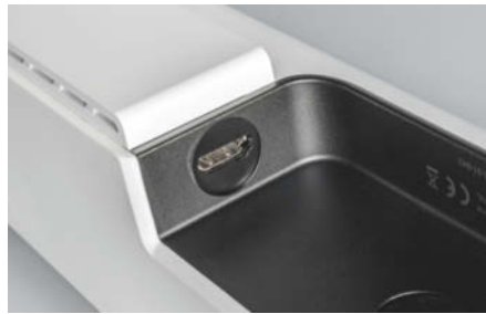
Auf der Rückseite der Arc findet man den HDMI-Port. Er ist der einzige Signalweg in die Soundbar.
