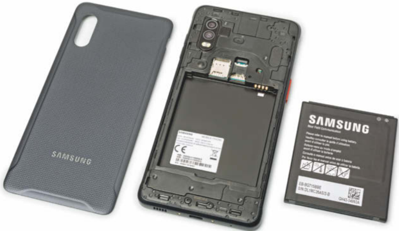
Praktisch: Beim Samsung Galaxy XCover Pro lässt sich der Akku ohne Werkzeug wechseln.
