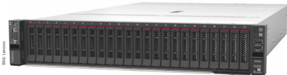
Im Lenovo ThinkSystem SR665 rechnen zwei AMD Epyc 7002; sie binden bis zu 4 TByte RAM, 32 NVMe-SSDs und sechs Rechenbeschleuniger an.
