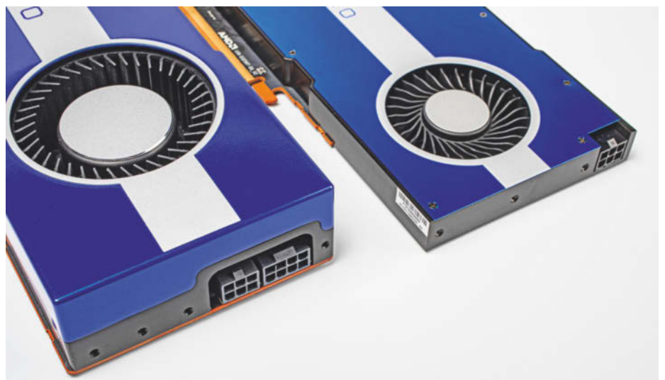
Radeon Pro W5500 (rechts) und W5700 (links) unterscheiden sich äußerlich nicht nur in der Dicke des Kühlers, sondern auch in ihren Anforderungen an das Netzteil mit einem Sechspol- respektive je einem Sechs- und einem Achtpol-Anschluss.
