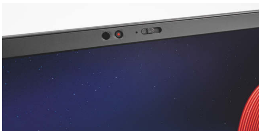
Mit einem mechanischen Schieber lässt sich die Linse der Webcam verdecken.
