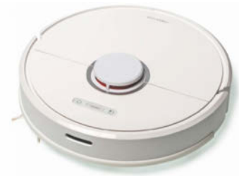
Saugbots machen sich zeitgesteuert auf den Weg und orientieren sich mithilfe von Infrarot- und Laserdistanzsensoren in ihrer Umgebung.
