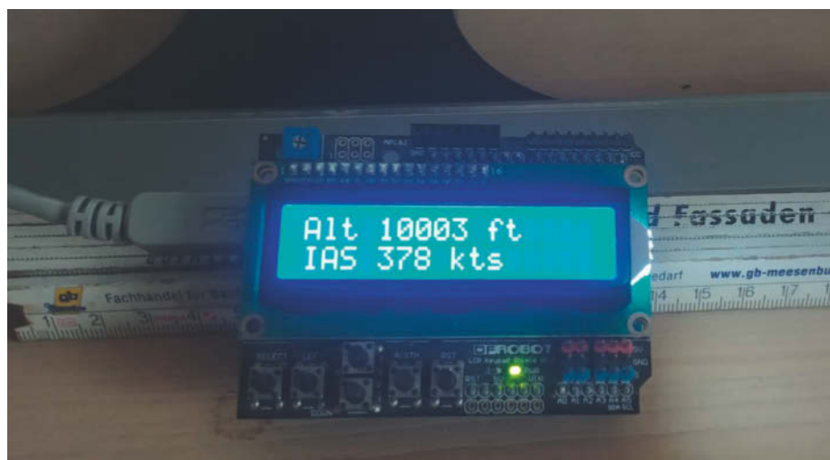
Das c't-Beispielprojekt zeigt Flughöhe und Geschwindigkeit aus Microsofts Flugsimulator auf einem Textdisplay am Arduino an.
