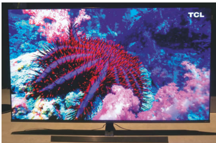
Der chinesische Displayspezialist TCL zeigte schon vor drei Jahren erste LCD-Fernseher mit einem Backlight aus Mini-LEDs.
