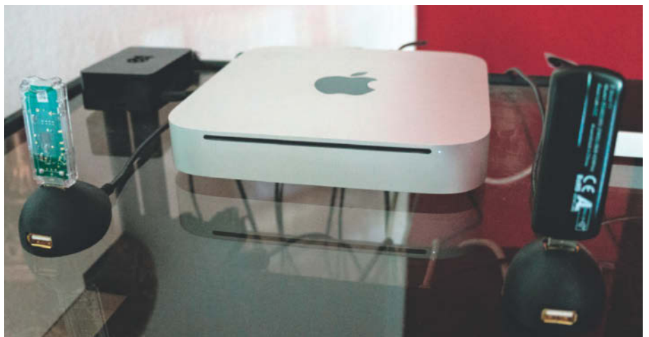
Die Steuerungssoftware läuft auf einem Mac mini, links sieht man den Raspberry Pi als EnOcean-IP-Bridge. Im Vordergrund stehen die jeweiligen USB-Funksticks auf Standfüßen.
