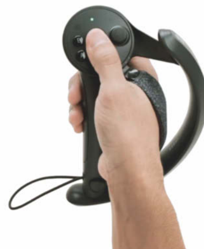
Der Valve-Controller (rechts) erfasst Streckung und Neigung jedes Fingers einzeln, der Oculus-Controller (links) nur Daumen und Zeigefinger, den Rest als Gruppe.
